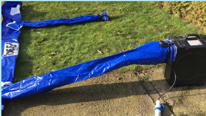
Den 2. Luftschlauch verschließen, möglichst zusammenrollen und unter Klett verstecken
